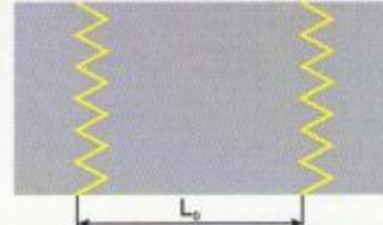
Разметка "Обозначение границ зоны остановочного пункта трамвая, расположенного на одном уровне с проезжей частью дороги"
